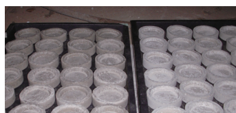
床下に設置したモルタル試験皿の様子
